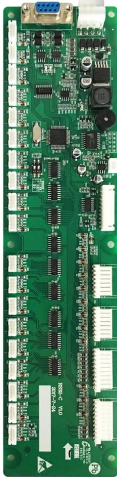
特点：RS32 板是能接收 RSL 总线上的时钟信号和数据信号，实现楼层数据输出；能提取 32 个 RSL 输出信号，用于外部指示；能提取外部 32 个输入信号，并生成 RSL 信号用于系统输入；
